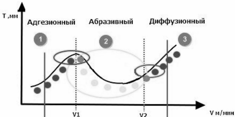
Рисунок 1 – Выделенные основные зоны износа режущего инструмента, через отношение стойкости режущего инструмента и скорости резания
